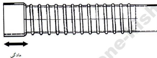
شکل ۴- نمونه‌ای از اتصال کوبلر متصل به لوله (کوبلر سرفود)
