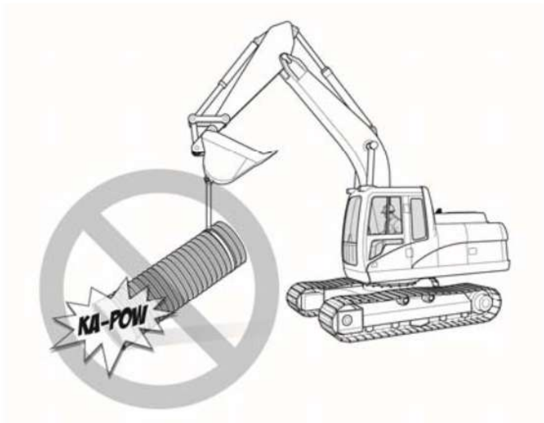
شکل ۴ : روش غیر قابل قبول بلند کردن لوله‌های کاروگیت با قطر بالا (عدم تراز بودن لوله و کشیده شدن روی زمین)
